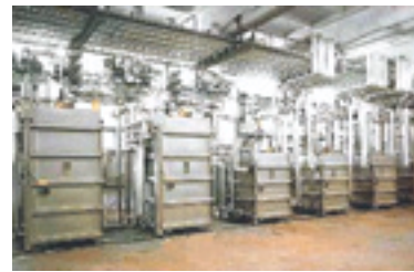
Figura 3.92. Armarios para la tintura con carro extraíble (Marca: Bellini).
