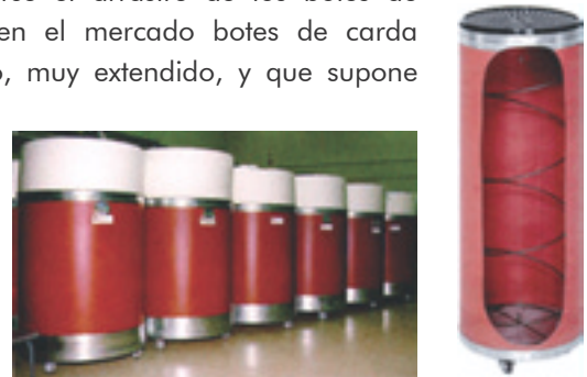
Figura 3.31. Botes de carda con ruedas y plato elevador. (Empresa: Serra y Llaurado).
