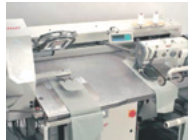
Figura 3.165. Unidad automática de alto rendimiento para colocar bolsillos de camisas y blusas. Pfaff 3588-02/021.
