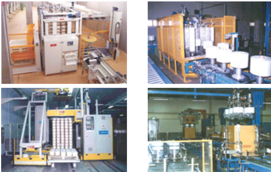
Figura 3.44. Sistemas automáticos de empaquetado y paletización de bobinas (Marcas: Electro_Jet, Satmoiraghi y Gualchierami).
