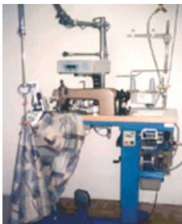
Figura 3.166. Máquina de festón automática (izquierda), y overlock automática con guiador de cantos para (manteles, mantas, etc.) MATIC, S.A.
