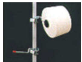
Figura 3.83. Clavijas giratorias para las bobinas. (Marca: Alandale)
